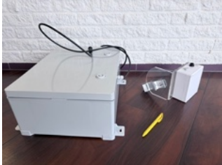
Figuur: radar wordt op 3 meter hoogte geplaatst op bv OV mast (op de foto rechts), accupakket (met zonnepaneeltje (niet zichtbaar op foto)) uit het zicht bv op de grond (op de foto links)
