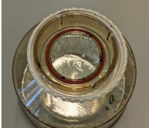
Figuur B3 - Aan de onderzijde van de trechter blijven enkele bandenslijtagegedeeltes plakken. Deze konden na drogen zorgvuldig weggeveegd en opgevangen worden.
