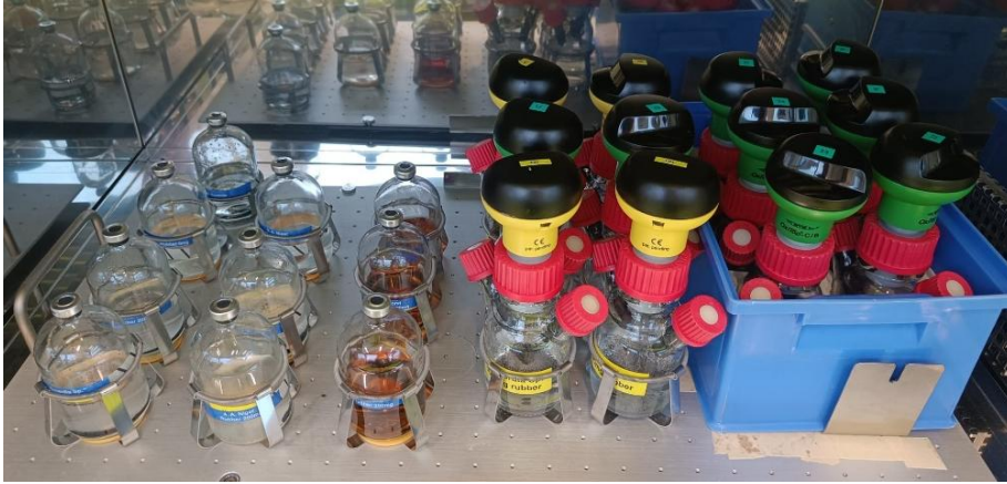
Figuur 5 - Gebruikte proefopstelling; alle test en controle flessen in de schudbroedstoof op 30 graden Celsius en 100 rpm.
