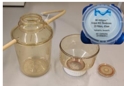
Figuur B2 - Geteste Nalgene® Reusable 1L Vacuum Filter vacuümfiltratie opstelling en membraamfilters
